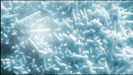
Trockeneis-Pellets haben einen Durchmesser von 3 mm und werden gleichermaßen als Strahlmittel, für das Trockeneis-Strahlverfahren als auch zum Kühlen eingesetzt.
